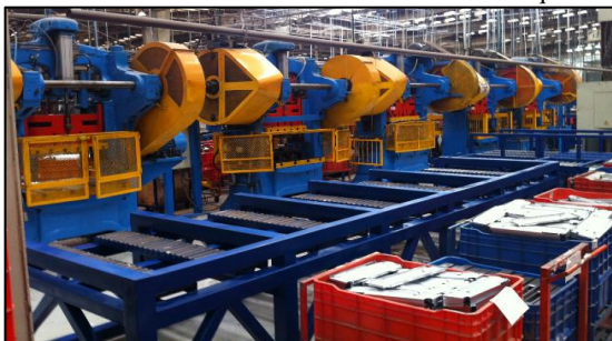
Figura 8. Área Trasera de las Prensas con Rack y Carros de Traslado colocados
