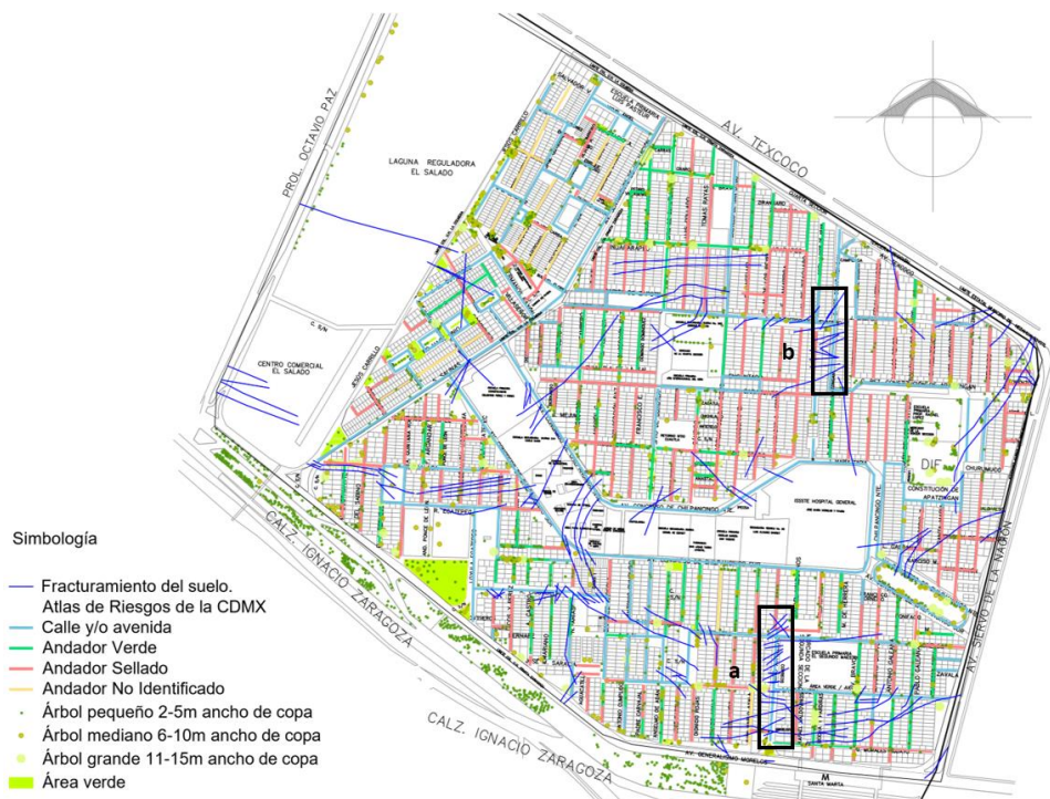
Figura 2. Identificación de áreas selladas en la U. H. Ermita Zaragoza. (a) Avenida Niño Artillero en Sección B y (b) Avenida Retorno de Apatzingán en Sección D. Elaboración propia con base en Fracturamiento de la CDMX. 2020 http://www.atlas.cdmx.gob.mx/analisisn2/
