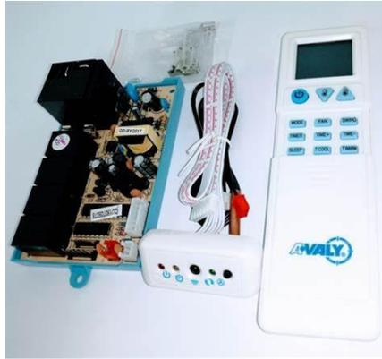
Figura 2. Tarjeta de control para aire acondicionado tipo Universal.
