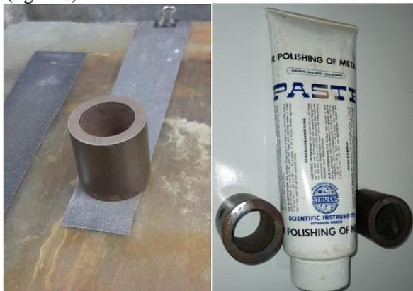
Figura 5. Pulido y acabado a espejo con alúmina
