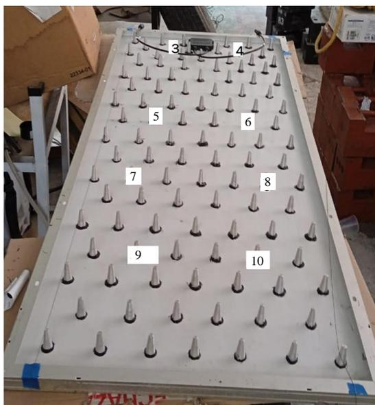
Figura 7 Termopares en aletas
