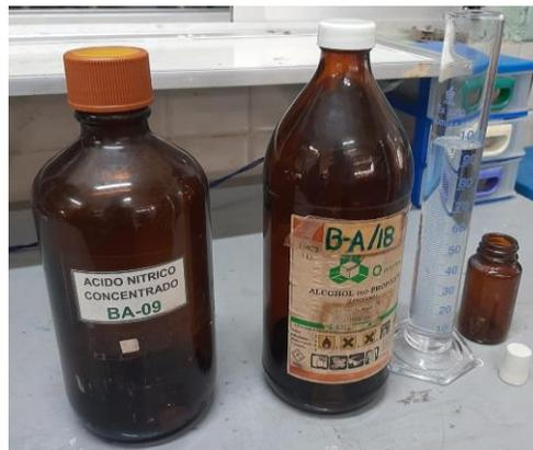
Figura 6. Preparación de nital al 4%
