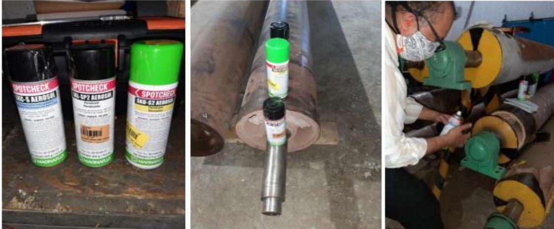
Figura 4. Ejecución de prueba de líquidos penetrantes
