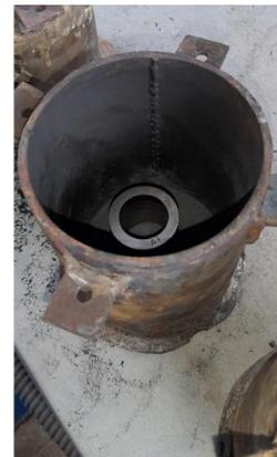
Figura 2. Buje en reactor
