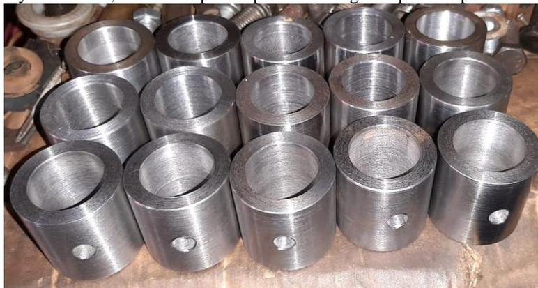
Figura 1. Bujes listos para borurado
