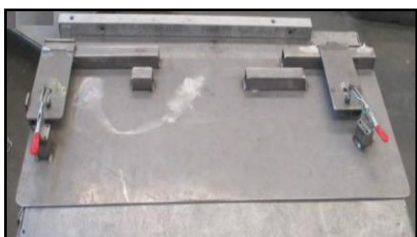
Figura 8. Poka-Yoke de prevención y control de parte F9-0282.
