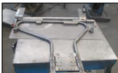
Figura 9. Parte F9-0282 montada en Poka-Yoke de prevención y control.
