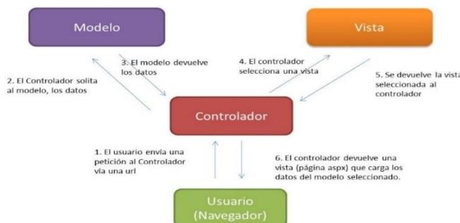
Figura 1. Diagrama del modelo (MVC).
