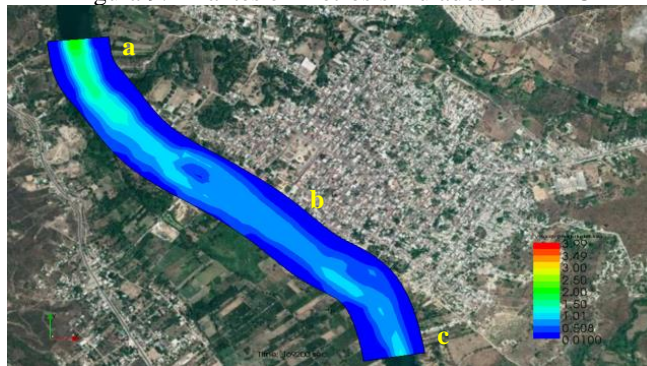
Figura 10. Velocidad en m/s simulados con IRIC
