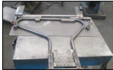
Figura 9. Parte F9-0282 montada en Poka-Yoke de prevención y control.
