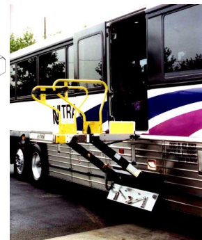
Figura 3. Plataforma RICON Mirage F9A Series Instalada.
