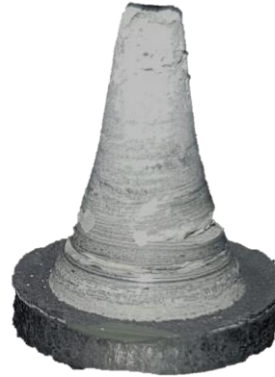
Figura 3. Pieza cerámica de nitruro de silicio sinterizada y extruida de forma simultánea a 1500°C/5 min.
