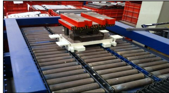
Figura 9. Colocación de Troquel en Rack
