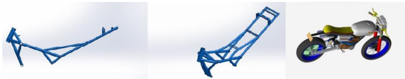
Figura 1. Diseño del chasis en SolidWorks.
