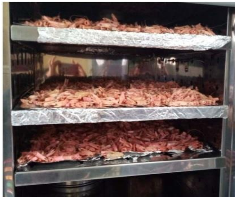
Figura 1. Proceso de secado de la materia prima en un secador de la moringa en un secador de convección.
