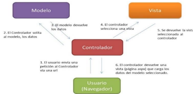
Figura 1. Diagrama del modelo (MVC).
