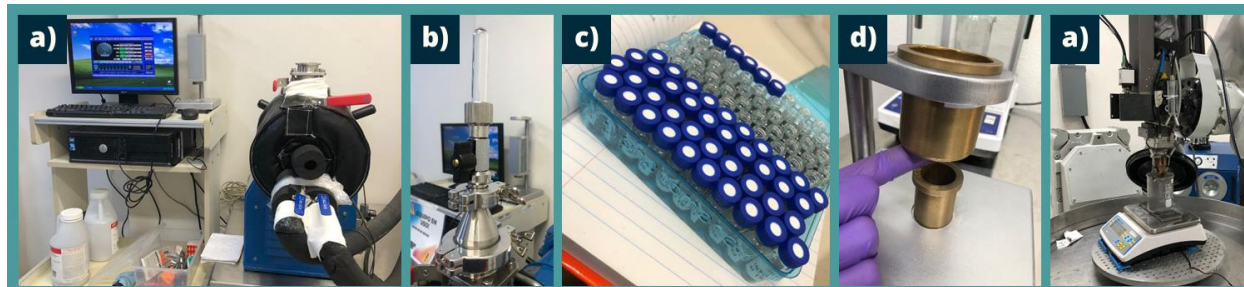
Figura 5.- Secciones de la caracterización: a) Equipo HEBM en proceso de molienda, b) Aditamento para tomar muestras de polvo, c) Muestras de polvo tomadas durante la molienda, d) Aplicación de la norma ASTM-B213, e) Pruebas de fluidez en cabezal Cladding.
