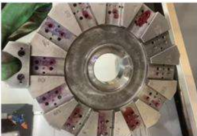
Figura No. 3: Torreta dañada Fuente: Elaboración propia
