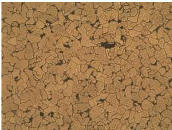
Figura 2. Micrografía de la sección transversal del acero AISI/SAE 1018 en estado de suministro.
