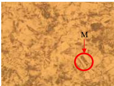
Figura 3. Microestructura del acero inoxidable AISI 304, testigo. donde se observa la presencia de granos poligonales correspondientes a la fase austenítica. 10 X.
