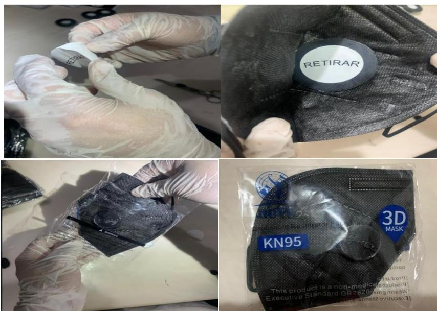
Figura 7. Colocación del sello y empaquetado de cubrebocas KN95 con el sistema de contención
