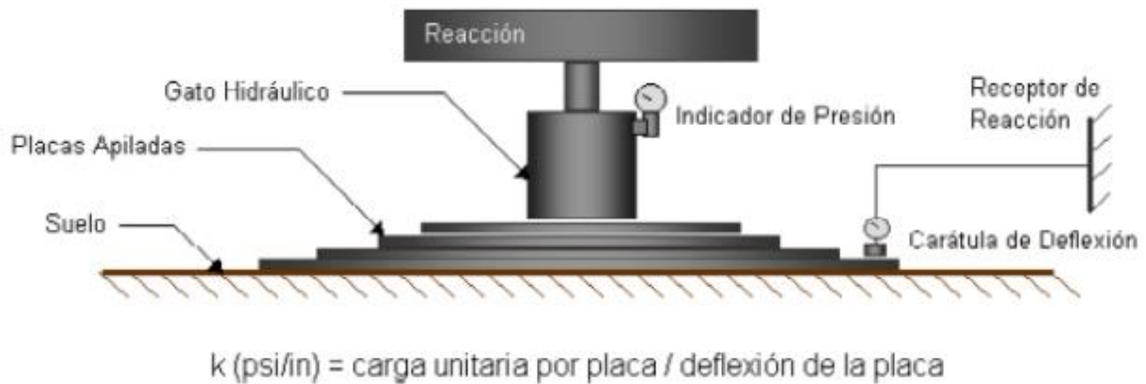
Figura 1.- Equipo para prueba de placa
