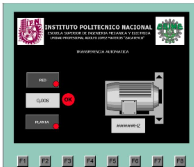
Figura 4. Diseño de HMI
