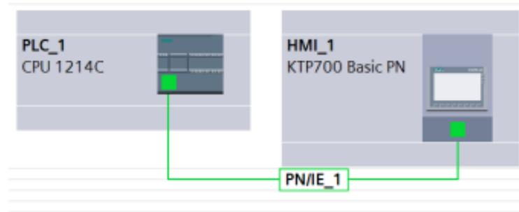
Figura 3. Conexión PLC-HMI
