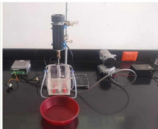
Figura 2 Celda de flotación equipada.
