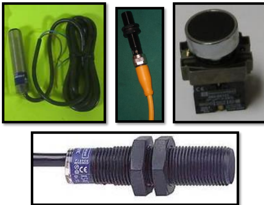
Figura 9 Elementos de Entrada de PLC (Imagen Propia)
