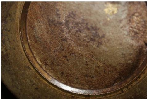
Figura 10. Zona de fractura en rodillo de lona tipo B 2
