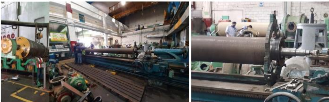
Figura 3. Montaje y rehabilitación de espigas en rodillos de lona tipo B
