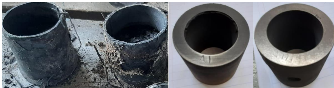
Figura 4. Reactores extraídos de hornos y bujes limpiados después del proceso de borurización
