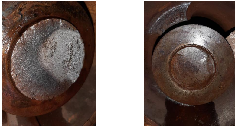
Figura 2. Preparación de las superficies para el examen fractográfico
