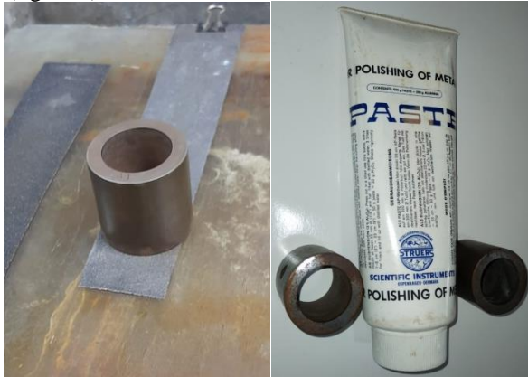
Figura 5. Pulido y acabado a espejo con alúmina
