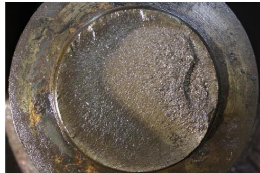
Figura 11. Zona de fractura en rodillo de lona tipo B 4
