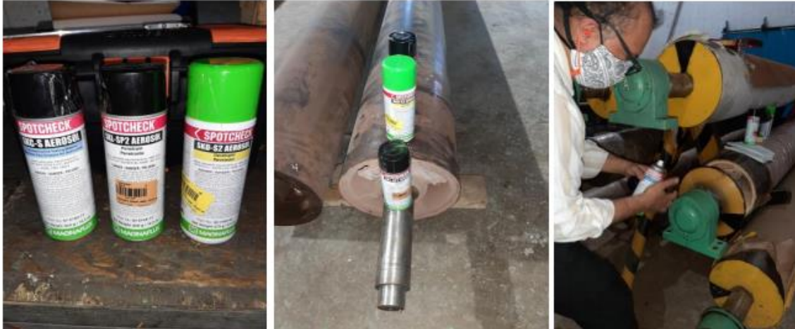
Figura 4. Ejecución de prueba de líquidos penetrantes
