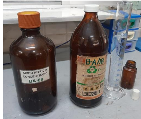
Figura 6. Preparación de nital al 4%
