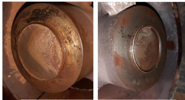
Figura 5. Fractografía en espigas de rodillos de lona tipo B con registro 2 y 4
