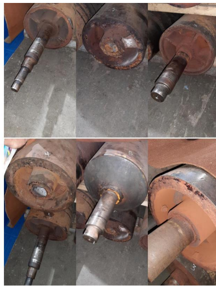
Figura 7. Condiciones en espigas de rodillos retirados de servicio
