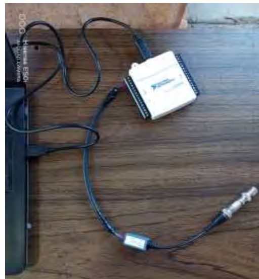
Figura 3. Conexión entre tarjeta NI USB 6009 y transductor PX35.
