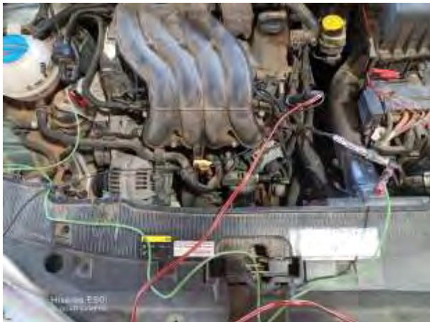
Figura 2. Instalación de transductor de presión.
