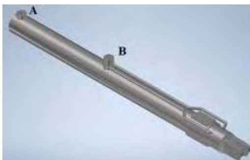
Figura 3. Actuador lineal de máquina para perforación.
