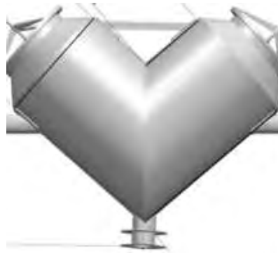
Figura 4. Diseño de la Mezcladora v en SolidWorks
