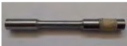
Figura 6. Probeta para ensayo de tensión.
