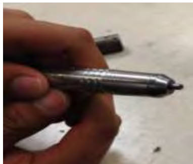
Figura 1. Lápiz neumático con punta de diamante.
