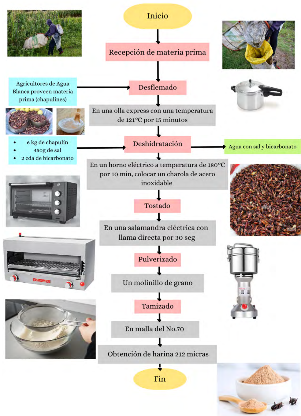
Figura 1. Diagrama de flujo para la obtención de polvo de chapulín ( Sphenarium Purpureans )
