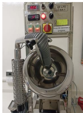
Figura 4. Paila grageadora del Laboratorio de Tecnología Farmacéutica
