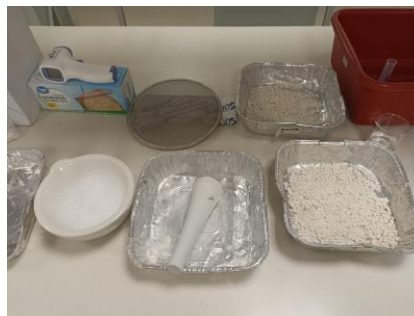
Figura 1. Proceso de granulado manual para la obtención de los núcleos
