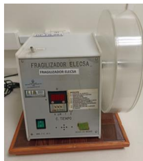
Figura 2. Fragilizador Elecsa del LTF empleado en la prueba de friabilidad
