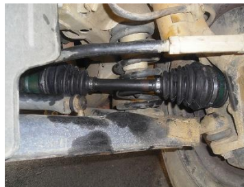
Imagen 4 Fuga de grasa
