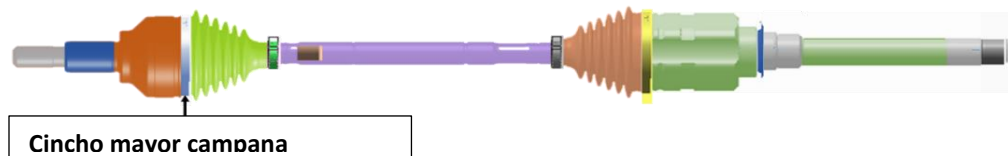
Imagen 5 Detalle de cincho mayor campana crimpado.
