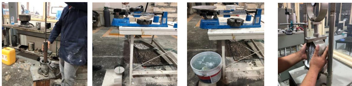
a) Elaboración de probetas b) Peso en el aire c) Peso en el agua d) Estabilidad Figura 4.- Procedimiento, estabilidad Marshall.
