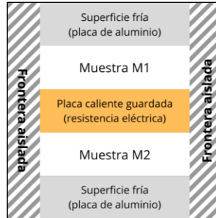
Figura 1. Arreglo general de los componentes mecánicos del conductímetro.
