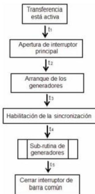
Figura 2. Esquema de algoritmo para la secuencia de transferencia automática al sistema de emergencia.
