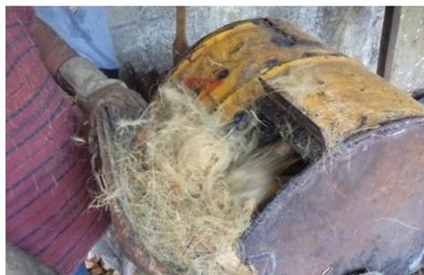
Figura 1. Procesamiento de fibra de coco a fibras tipo estopa.
