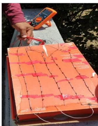
**Figura 5. Celda solar a base de diodos.**
