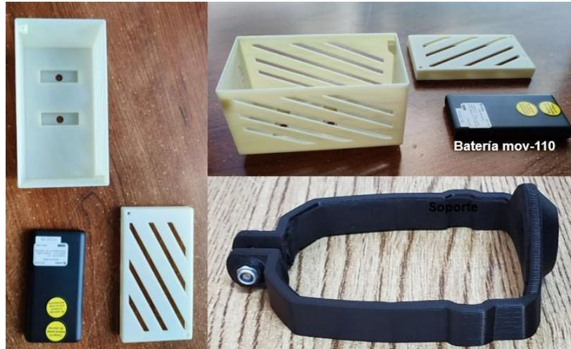
Figura 3. Soportes para acoplar el dispositivo al dron impresos en 3D.
