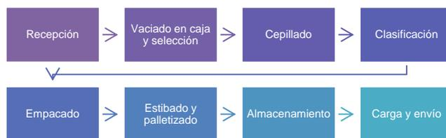
Figura 1. Diagrama de Bloques del Proceso de Empaque de Tomate.
