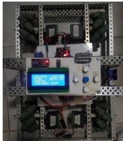
Figura 3. Móvil construido con llantas mecanum
