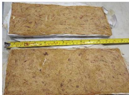
Figura 2. Probetas para ensayo de flexión.
