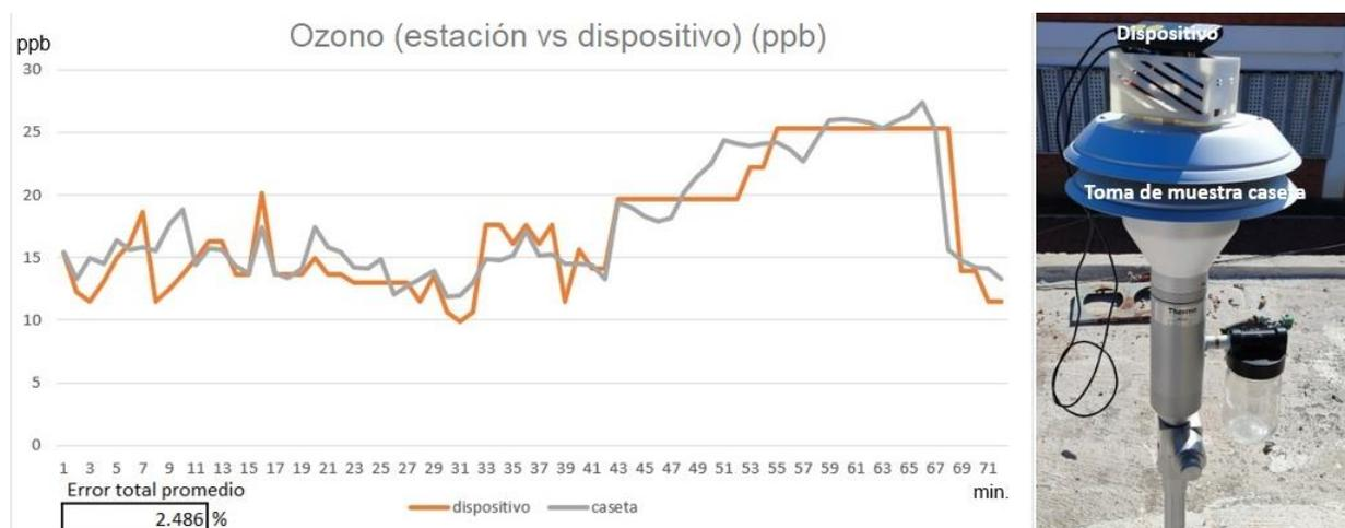
Figura 5. Validación de datos del dispositivo con la estación de monitoreo atmosférico para ozono.
