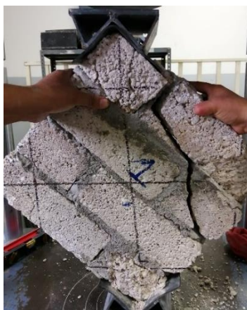
Figura 6. Falla del murete combinada.
