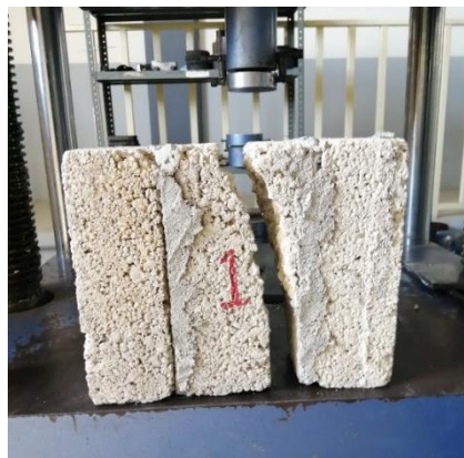
Figura 5. Falla por cizallamiento de pieza.
