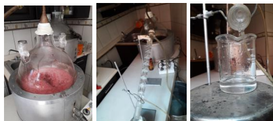
Figura 4. Proceso de destilación en un alambique simple.
