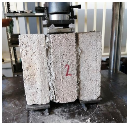
Figura 4. Colocación de la probeta para ensaye.
