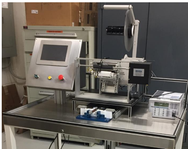
Figura 8. Estación de prueba y etiquetado de fusible
