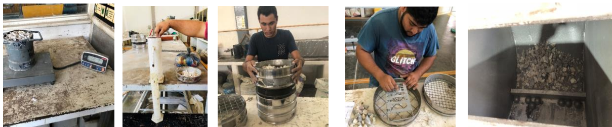
a) Peso volumétrico b) Densidad c) Granulometría d) Partículas alargadas e) Desgaste Los Ángeles
