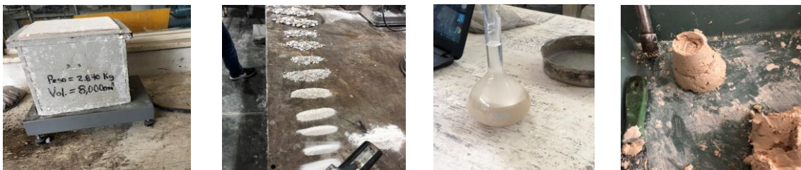
a) Peso volumétrico b) Granulometría c) Densidad d) Absorción
