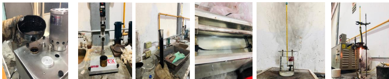
a) Viscosidad b) Penetración c) Densidad d) Ductilidad e) Reblandecimiento f) Inflamación Figura 3.- Pruebas al asfalto.
