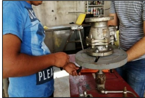
Figura 2 Montaje de válvula al banco y sujeta con método tradicional (tornillos con tuercas)
