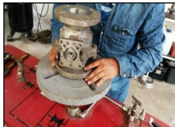
Figura 1. Presentación de una válvula en un banco de pruebas de fabricación artesanal
