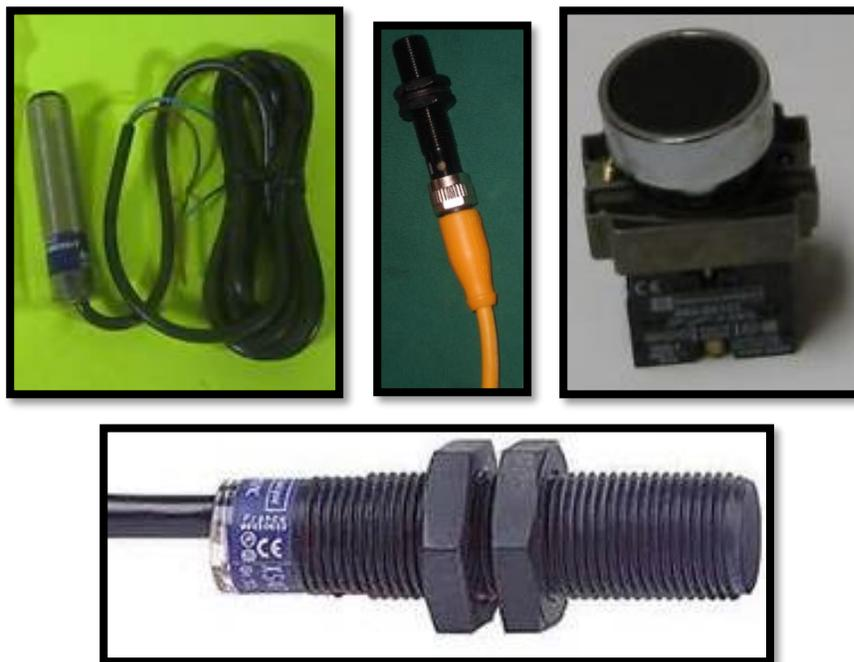
Figura 9 Elementos de Entrada de PLC (Imagen Propia)
