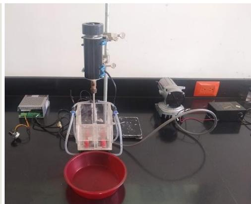
Figura 2 Celda de flotación equipada.
