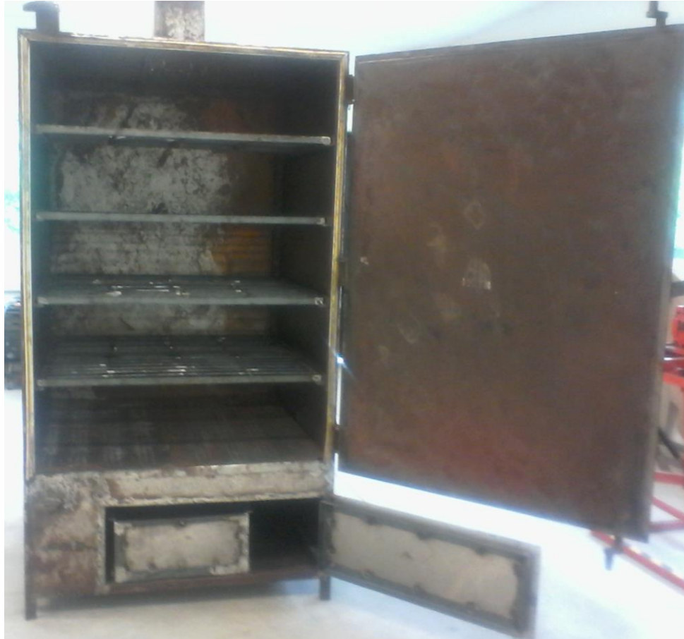
Figura No.3 Vista frontal del prototipo del horno para ahumar carne.
