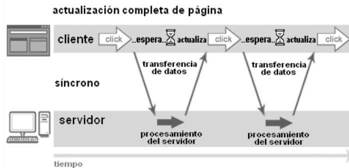
Figura 1. Modelo tradicional de una aplicación WEB
