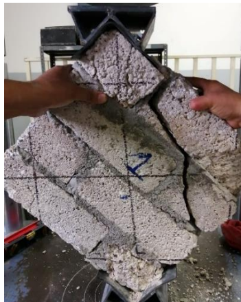
Figura 6. Falla del murete combinada.
