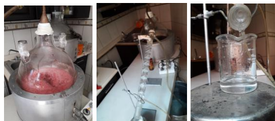
Figura 4. Proceso de destilación en un alambique simple.
