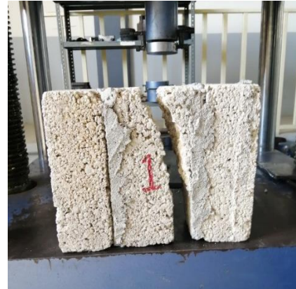
Figura 5. Falla por cizallamiento de pieza.
