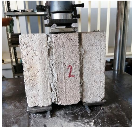
Figura 4. Colocación de la probeta para ensaye.
