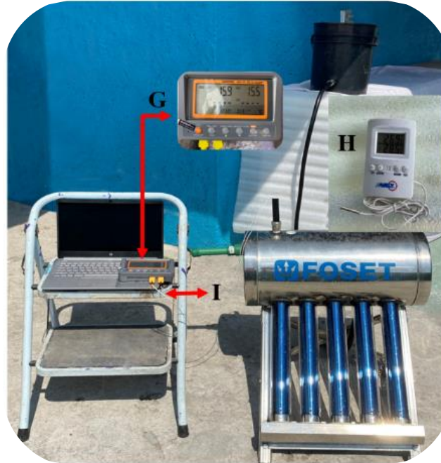
Figura 2. Instalación de sistema de calentamiento de agua solar in situ . El adquisitor de datos digital Data Logger SD (G), el AVALY (H) e (I) 2 termopares tipo K.
