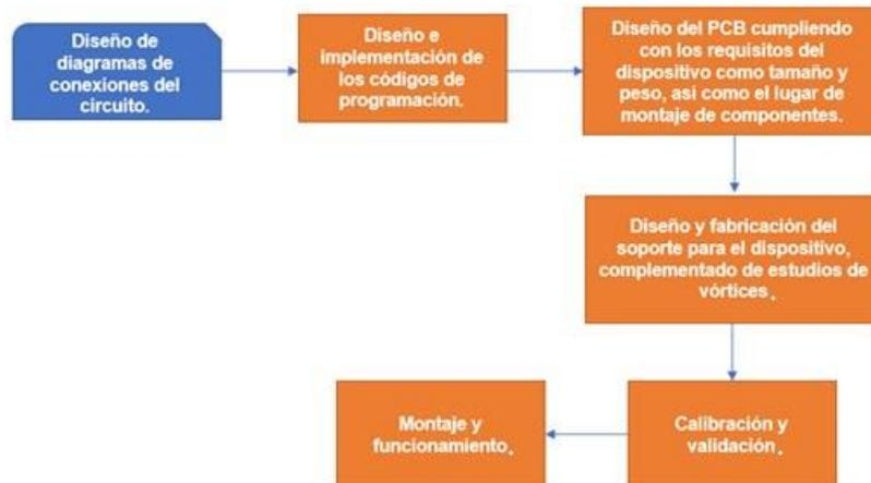
Figura 2. Diagrama de flujo metodología para el diseño del dispositivo.
