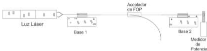
Figura 1. Esquema experimental usado en la caracterización del acoplador de FOP.
