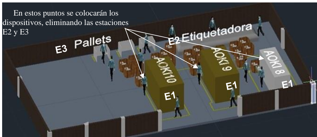
Figura 3: Distribución física de línea de máquinas AOKI
