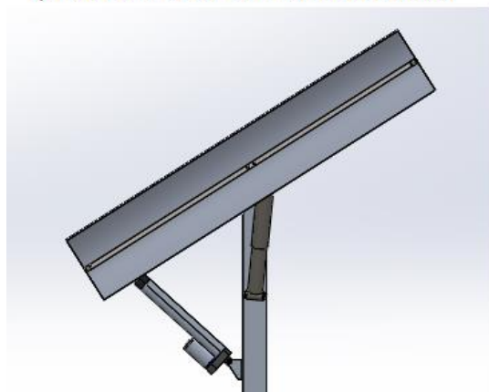
Figura 6. a) Estructura del seguidor solar con el actuador lineal retraído, b) estructura con el actuador lineal extendido.
