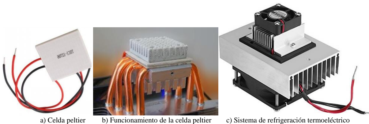
Figura 4. Identificación de celda peltier, su funcionamiento y sistema de refrigeración termoeléctrico
