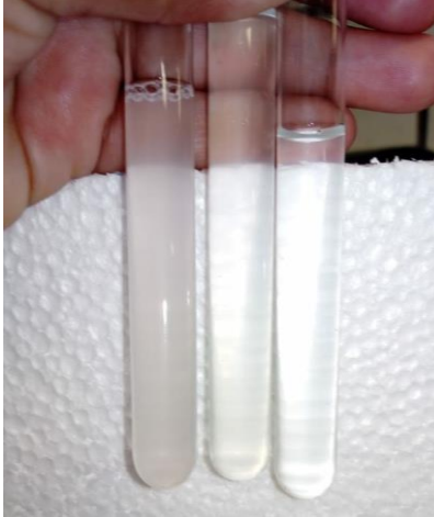
Fig. 2 Agua residual sin tratamiento/efluente del Sedimentador/ efluente de la filtración
