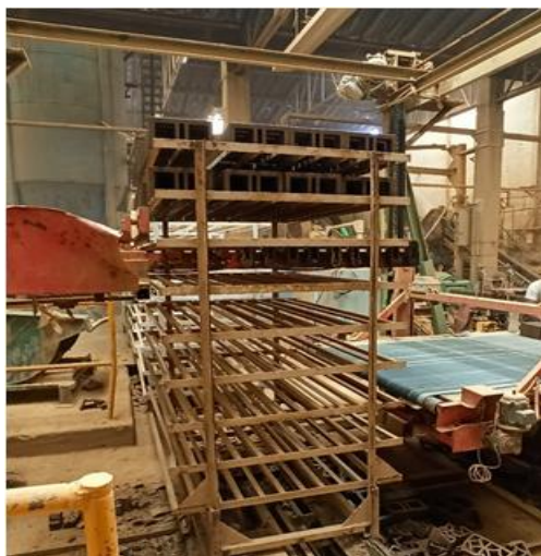
Figura 1 Racks donde se deposita el material extruido y cortado
