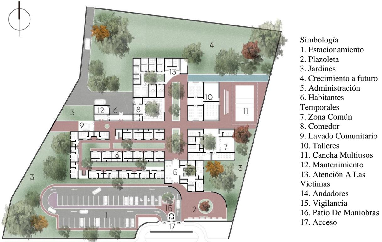
Figura 5: Planta arquitectónica
