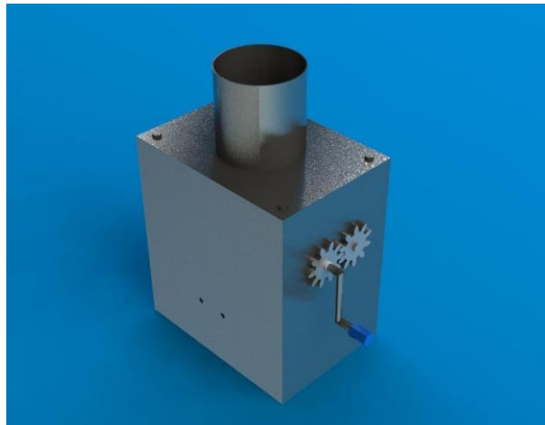
Figura 9 Imagen renderizada de la trituradora
