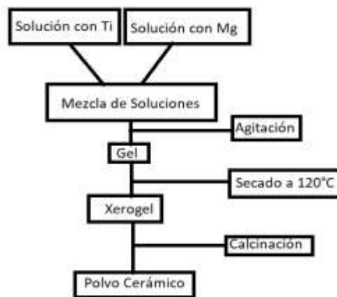
Figura 1. Diagrama de flujo para la mezcla de los óxidos
