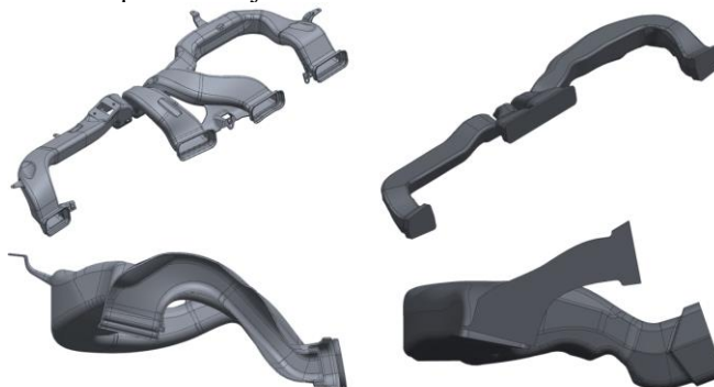
Figura 6. Modelado CAD y geometría interna para CFD. En la izquierda el modelado CAD y la derecha geometría preparada para CFD.
