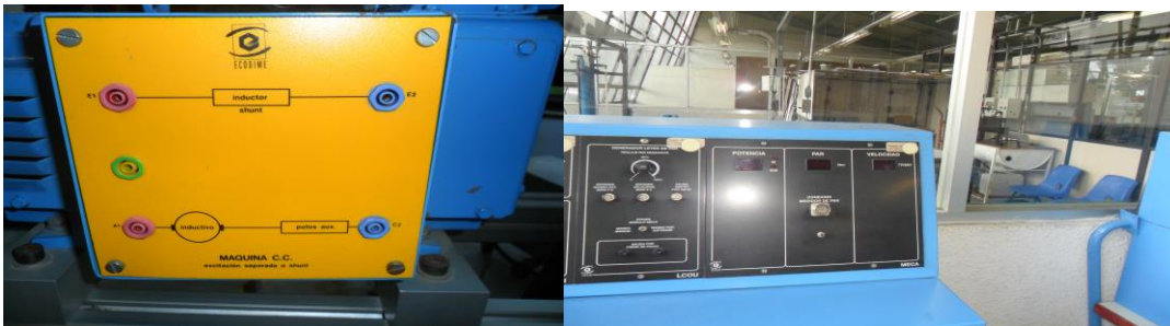
Figura 7 Motor de CD y Fuente de voltaje y medición de par y velocidad
