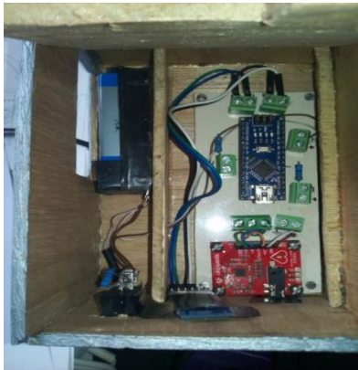
Figura 4. Prototipo: vista interior (Circuitos).
