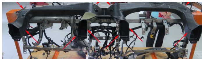
Figura 3. Ducto de aire acondicionado.
