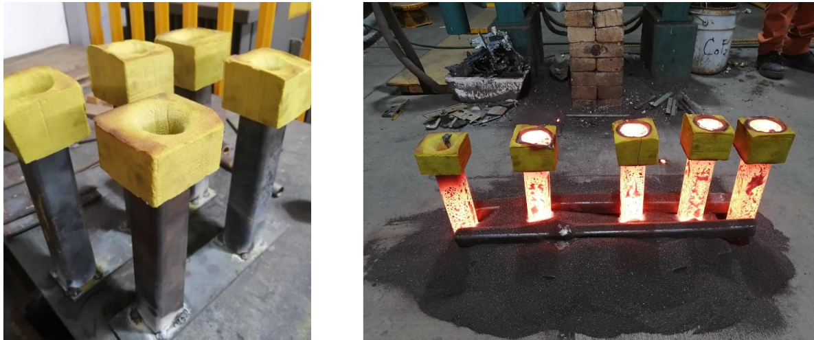
(a) (b) Fig. 1 Práctica de Fusión: a) Lingoteras y mazarotas. b) Acero colado en lingoteras.
