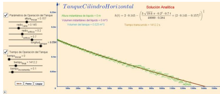
Figura 8. Applet terminado, datos experimentales (verde), solución analítica propuesta con k=0.7 (rojo).
