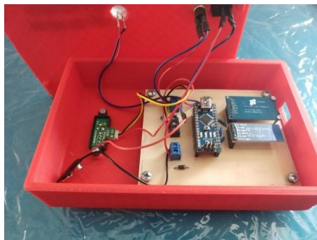
Figura 6. Diseño de la carcasa para el módulo, impresa en 3D.
