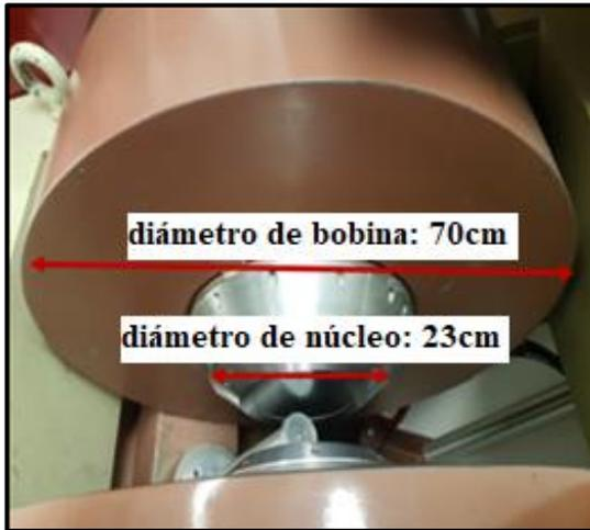
Figura 1 - Dimensiones de diámetros de bobinas y núcleo
