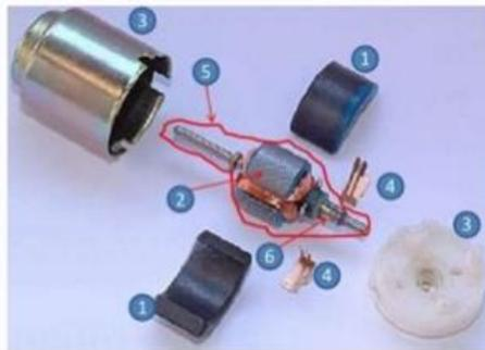
Figura 1 Partes de un Motor de C.D. [2]
