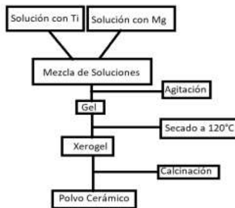
Figura 1. Diagrama de flujo para la mezcla de los óxidos
