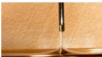
Figura 3. Determinación de tensión superficial en agua.
