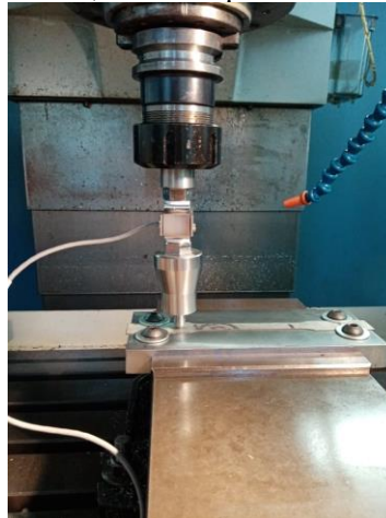
Figura 1: Probeta sujeta en molde durante el proceso de bruñido.
