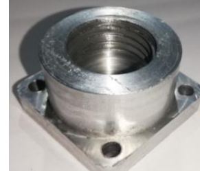
Figura 9: Acabado de pieza con torno manual
