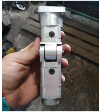
Figura 10: Prótesis de rodilla mecánica manufacturada en fresadora CNC y torno manual.
