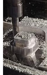
Figura 8: Maquinándose en Fresadora Promil 8000
