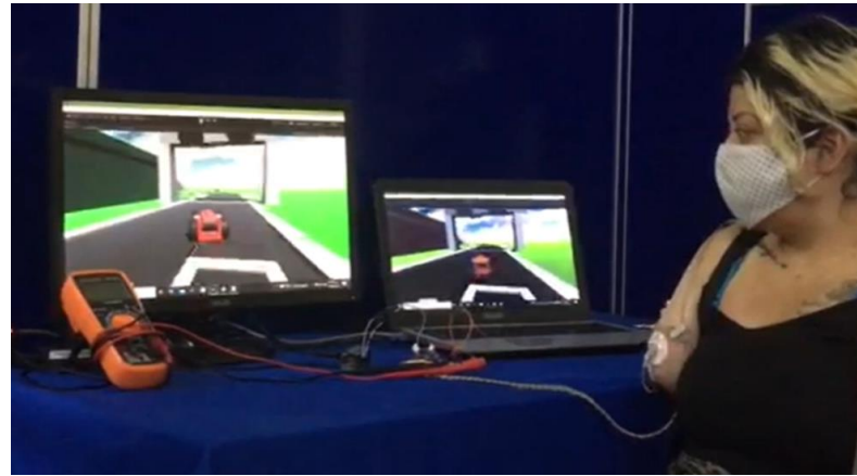
Figura 17: Prueba de la tarjeta EMG con videojuego de rehabilitación
