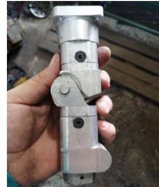
Figura 10: Prótesis de rodilla mecánica manufacturada en fresadora CNC y torno manual.
