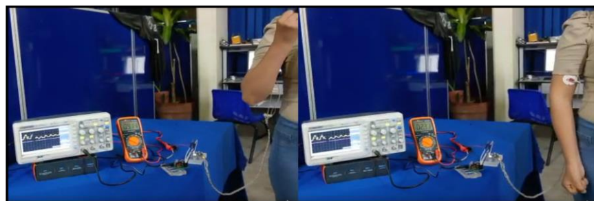
Figura 14: Tarjeta EMG en el musculo bíceps realizando curl sin mancuerna
