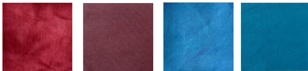
a) Tejido con álcali celulosa Tejido sin álcali-celulosa b) Tejido con oxixelulosa Tejido sin oxixelulosa Figura 1. Fotos de tejido con tintura diferencial para determinar depolimerización química
