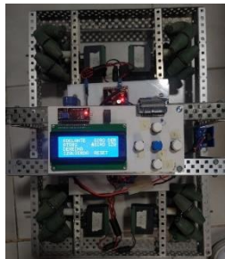
Figura 3. Móvil construido con llantas mecanum
