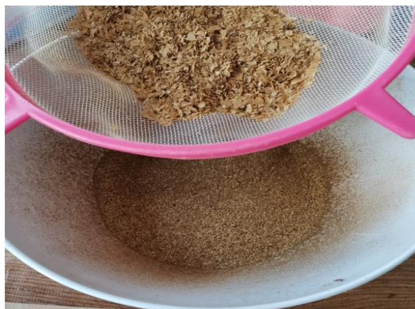
Fotografía 5: En esta fotografía se observa el proceso de tamizado el cual se realizó con un colador de cocina
