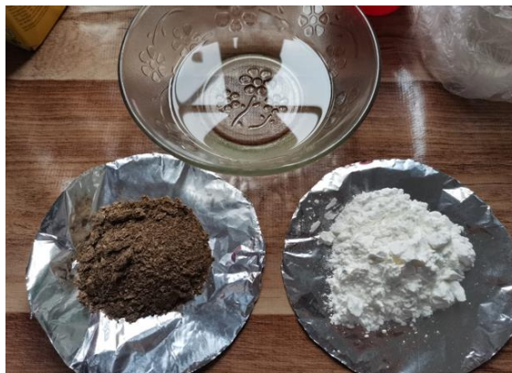
Fotografía 6: Se observa el proceso del pesado de los materiales, las medidas fueron tomadas con una cuchara sopera v de capacidad colmada.
