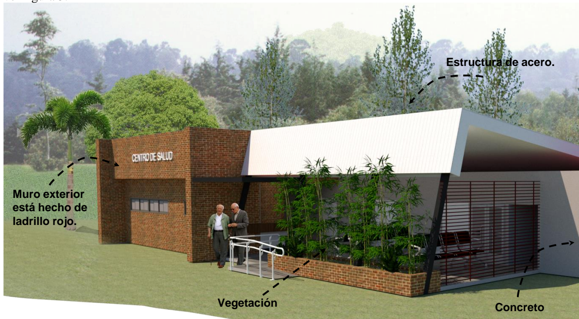
Ilustración 5 Vista esquemática elementos constructivos prototipo.
