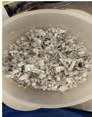
Fig.4. Triturado del polialuminio del tetrapack.
