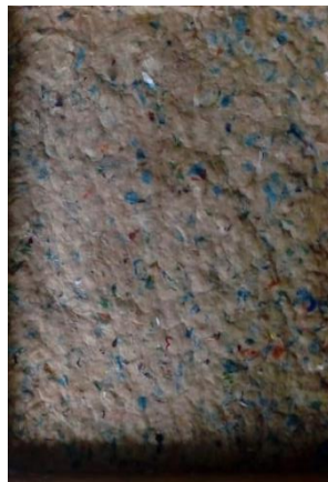
Fig. 5. Laminas formadas a partir del tetrapack.
