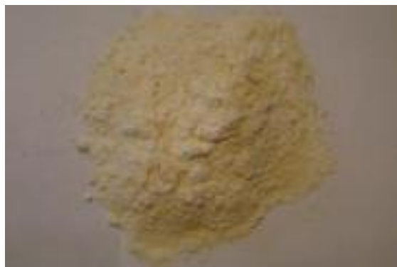
Figura 3. Almidón después de ser disecado, triturado y tamizado.
