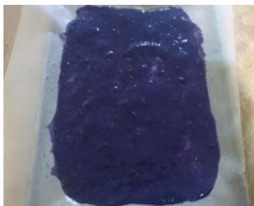
Figura 5. Mezcla de componentes para obtener bioplástico en secado.
