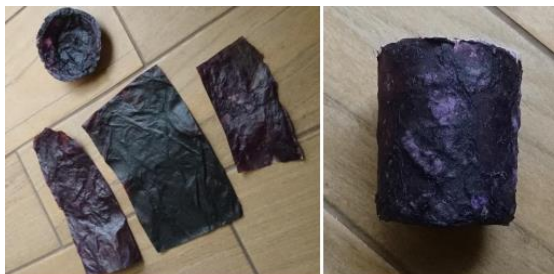
Figura 6. Bioplástico obtenido a partir de cáscara de plátano.
